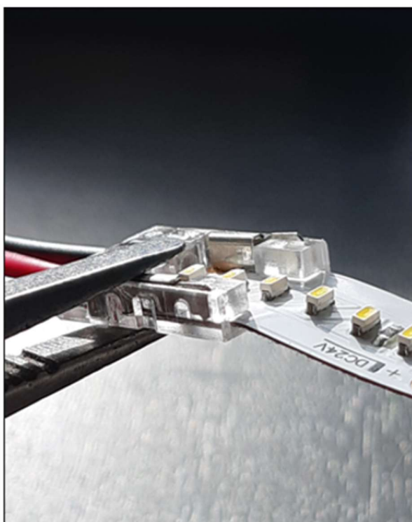
AVEC UNE PINCE PLATE PRESSER FORTEMENT SUR LES 2 PATES DE CONNECTIONS
